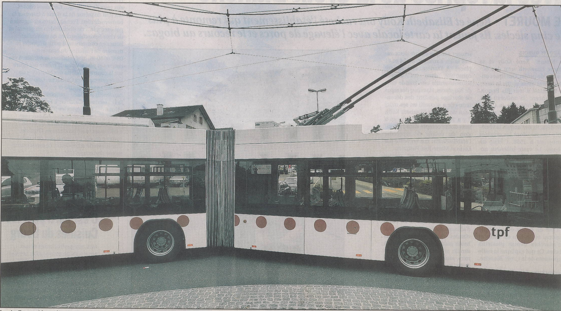
Les trolleybus ont beau être tout neufs, ils sont forcés de rouler à moins de 25 km/h dans les virages pour ménager les lignes électrifiées. ALAIN WICHT
